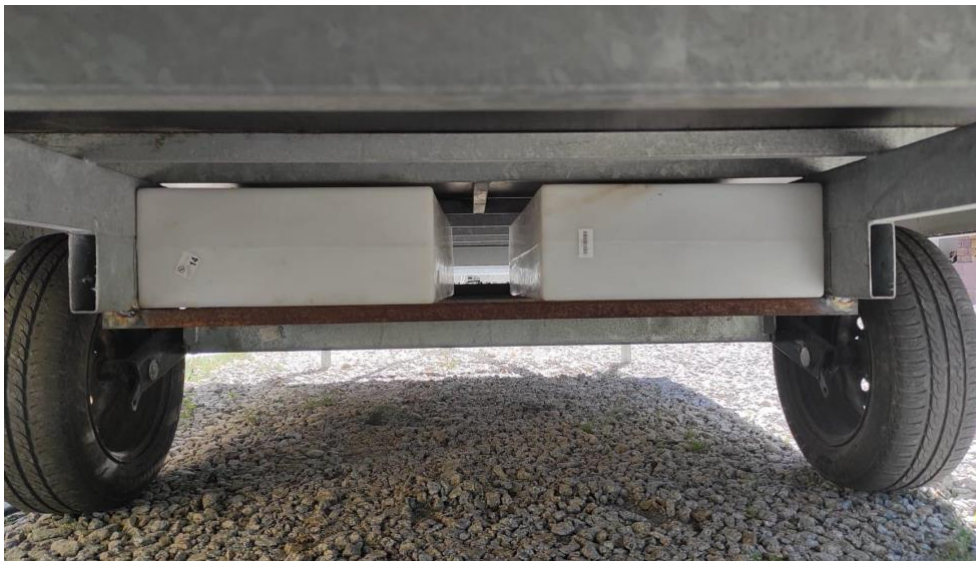
Fotografia nr 16. Zbiorniki na wodę szarą
